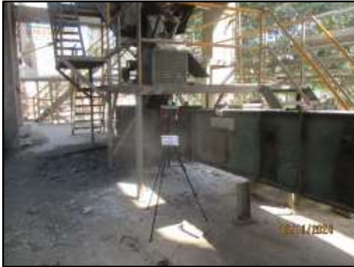
ภาพที่ 3.49 การตรวจวัดความร้อนในสถานที่ทำงาน บริเวณอาคาร Boiler WHG KK3
